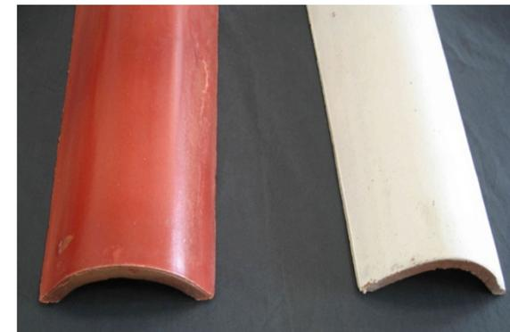
La radiazione luminosa viene assorbita o riflessa dal pigmento e va a formare il colore, la restante parte della radiazione solare incidente passa attraverso il rivestimento esterno e incide sul substrato bianco, da cui viene a sua volta riflessa indietro nell'atmosfera.
